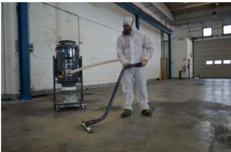
Nettoyage avec aspirateur filtration des fines
