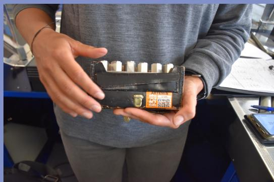
L'agent de contrôle procède à un essai de justesse d'une balance avec son kilogramme étalon.
