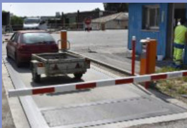
Réalisation d'un essai bout-centre-bout : une même charge est déplacée en trois points du pont-bascule afin de s'assurer du bon fonctionnement des différents capteurs qui équipent l'instrument. Si les cellules sont conformes, le même poids doit être retrouvé 3 fois. Les pesées sont concluantes.
