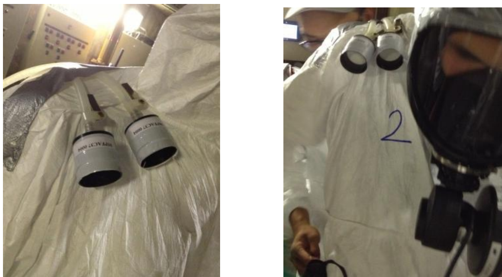
Figure 2 – Exemples de positionnement et de fixation des cassettes ouvertes sur l'opérateur (Photos A. Romero-Hariot / INRS)
