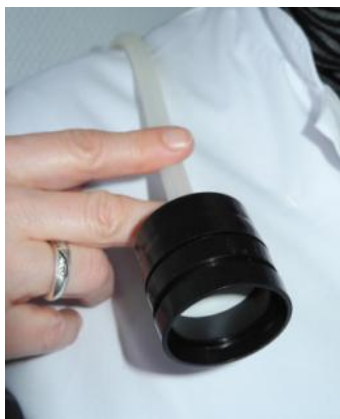
Figure 1 - Modèle de cassette à 4 étages en configuration ouverte (Photo C. Eypert-Blaison / INRS)
