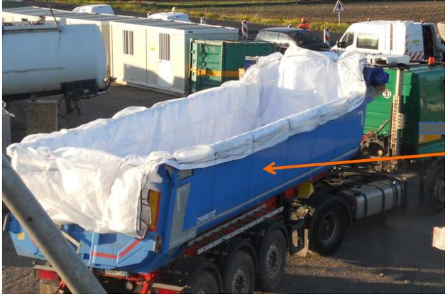
"Body-benne" maintenu en position ouverte par des liens fixés à l'extérieur de la benne.
