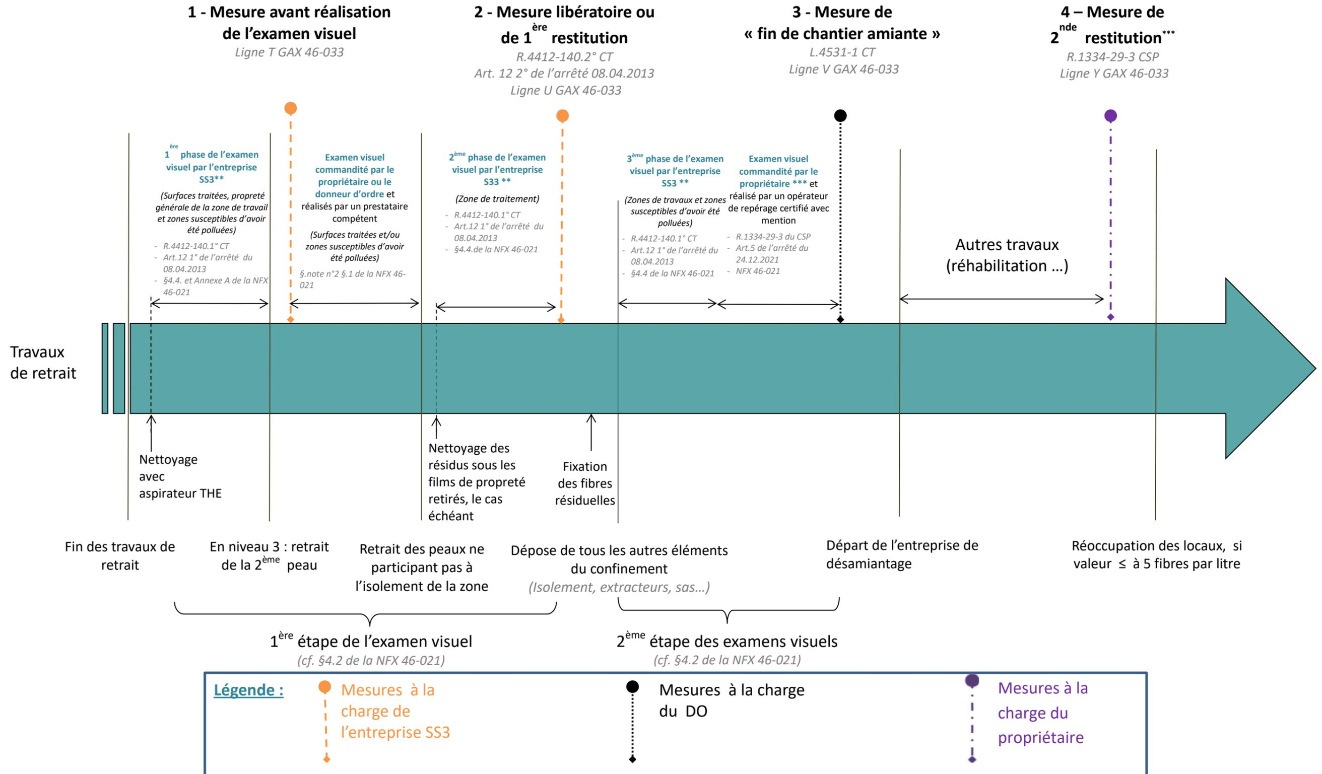
\* Confinement (niveaux 2 et 3) = isolation de la zone de travail vis-à-vis de l'environnement extérieur évitant la dispersion des fibres : isolement (séparation physique, étanche), calfeutrement, protection de la séparation physique si non décontaminable par 1 ou 2 films de propreté, création d'un flux d'air et mise en dépression de la zone (article 4 de l'arrêté du 08.04. 2013).
